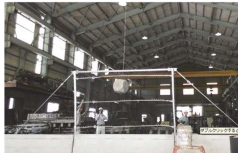
重錘衝突後の最大変形(正面)
